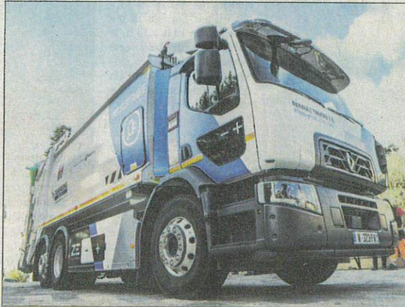
Durant quatre jours, le camion électrique a mené des tournées de plus de 100 km et récolté 400 bacs. Tout en conservant une autonomie de batterie de près de 30 %. Test concluant : reste à concrétiser... (DR)
